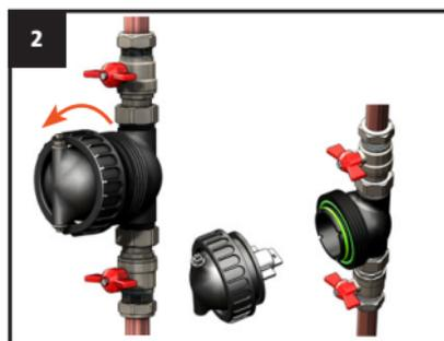
Réintroduire le robinet de vidange, desserrer le collier de serrage et déposer le bol et le noyau du filtre.
